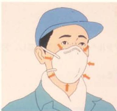
図7 陰圧法による漏れのチェック（定性的）
