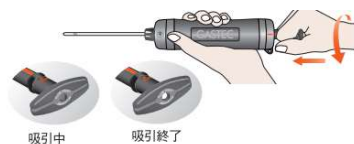
④所定の吸引時間やフィニッシュインジケータを目安に吸引終了を確認する
